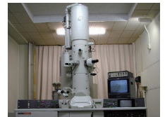
材料中の原子の並び方が見える透過電子顕微鏡
